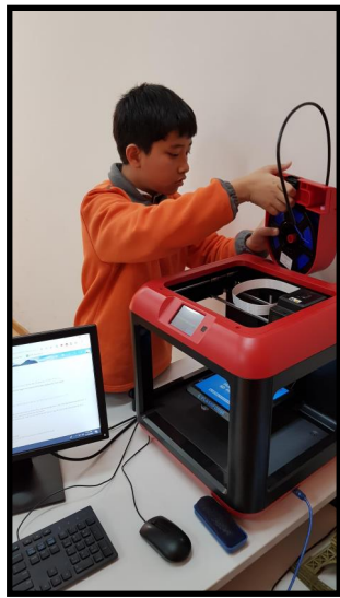
Một học sinh lớp 5 đang cho sợi PLA vào máy in 3D; Mô hình tháp Eiffel đã hoàn thành
